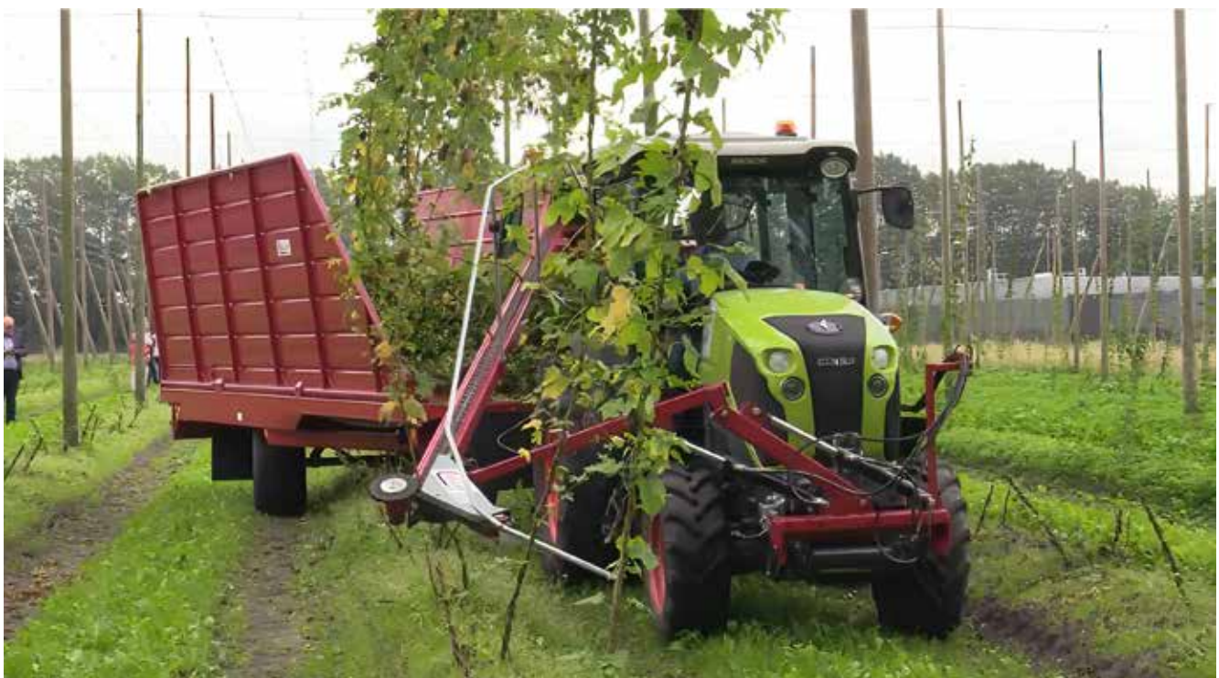
Figuur 3: Snijden, vastpakken en al rijdend lostrekken van de hopranken
