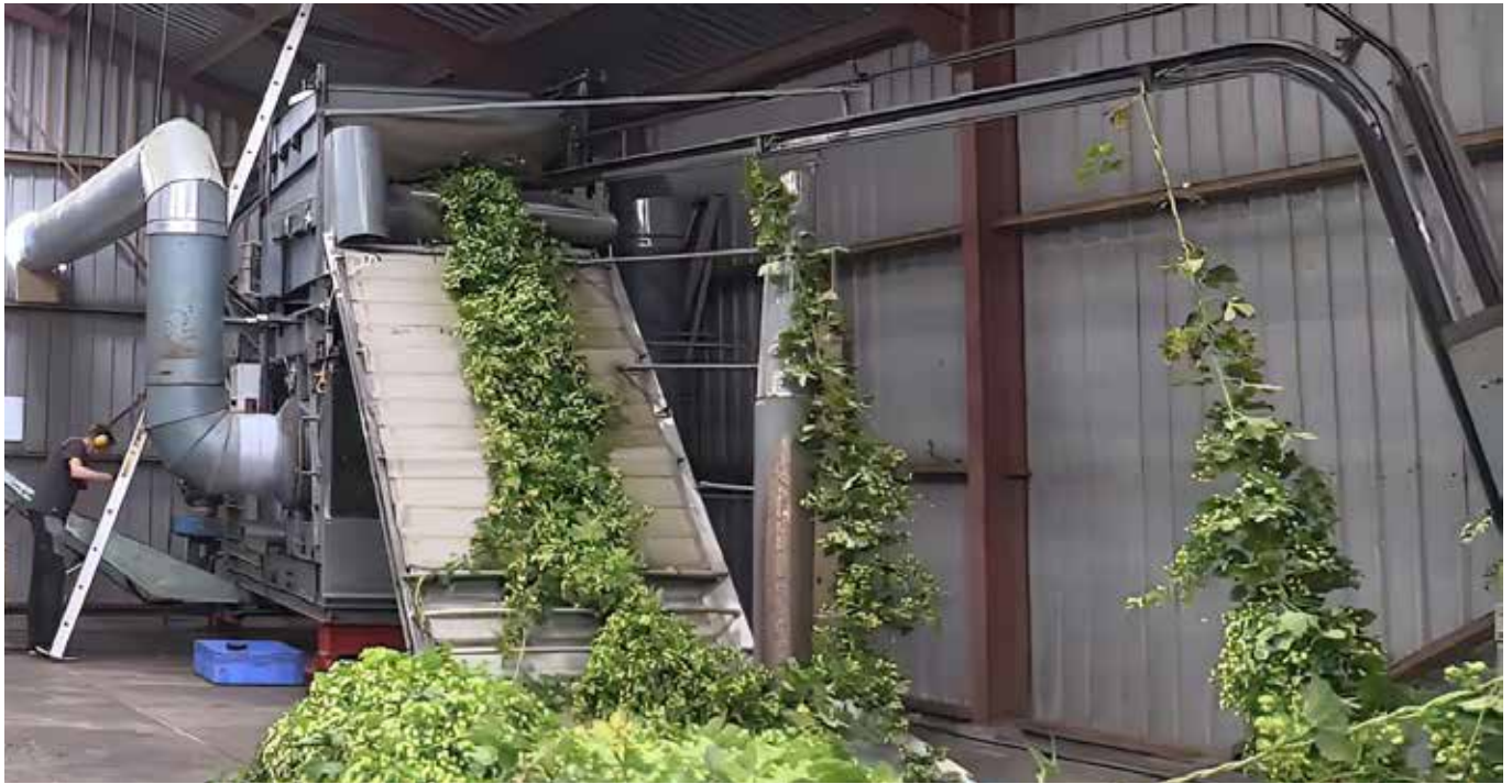
Figuur 4: Een plukmachine trekt bladeren en bellen van de ranken
